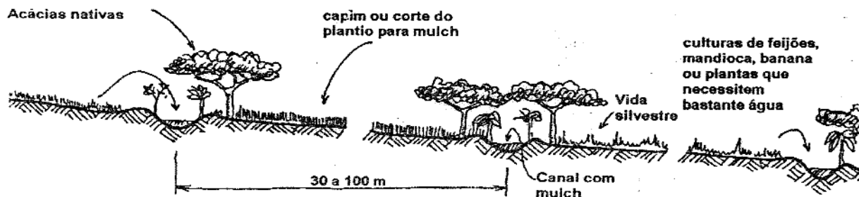
Figura 2.22 A distância entre os canais de infiltração em terras áridas é maior do que em climas úmidos. Estes canais produzem leguminosas forrageiras e árvores resistentes. O espaço entre eles pode ser semeado com capins ou cereais após as chuvas.
